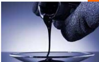
Le bitume de viscosité est principalement utilisé comme couche de pavage et il convient à la construction de routes et aux chaussées en asphalte produisant des attributs de premier ordre. Le bitume de viscosité est habituellement utilisé dans la production d'asphalte mélangé à chaud.
